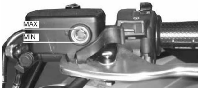
Finestrella ispezione liquido per leva freno (sul gruppo comandi sinistro e destro)
